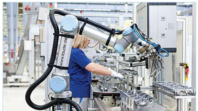
شکل ۱۰- یک بازوی رباتیک مشترک که می‌تواند با خیال راحت در کنار انسان کار کند [۱۰۰]
