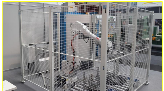
شکل ۸- یک بازوی رباتیک خودکار در داخل سلول کار کارخانه. این ربات در یک قفس قرار دارد تا از ایمنی انسان در مجاورت اطمینان حاصل کند [۱۰۰]
